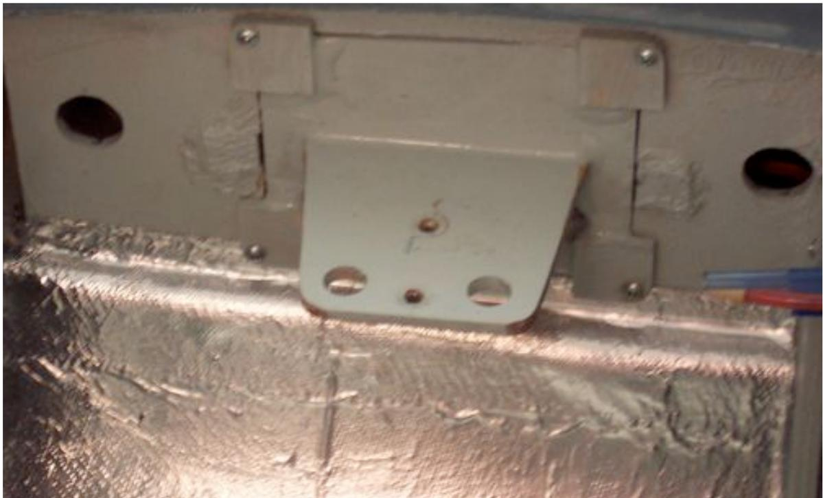
*Anmerkung : die hier zu sehenden Sperrholzungen liegen etwas zu tief, daher musste die Turbinenhalterung unterfüttert werden. Durch Entfernen dieses Bauteils gelangt man in die Flächenwurzel, die weiteren Raum für Hoppertanks bietet.*
