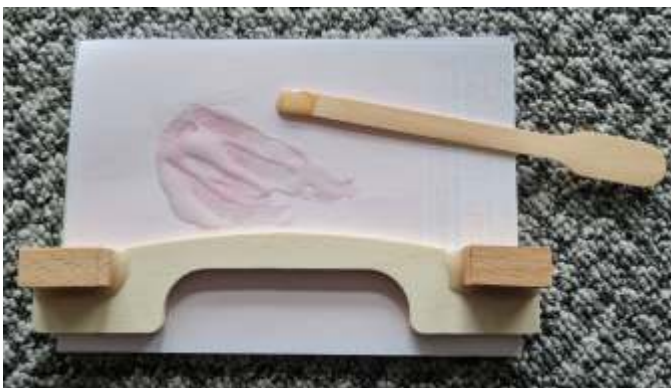
Brace with spacers, 12 x 12 x 22 mm Brücke mit Abstandhaltern 12 x 12 x 22 mm
