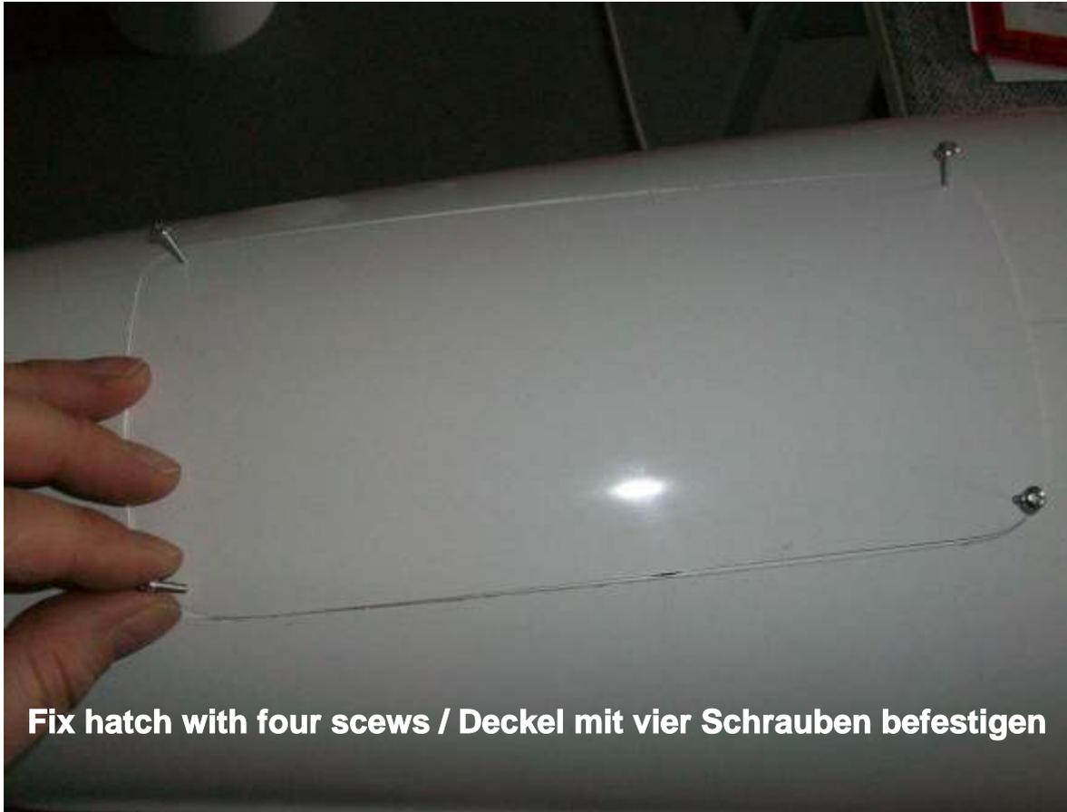
**Fix hatch with four screws / Deckel mit vier Schrauben befestigen**
